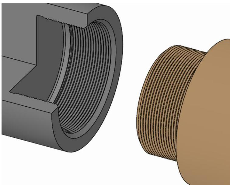
1. Das Wechselteil über dessen Gewinde aus dem Produkt herauserschrauben.
