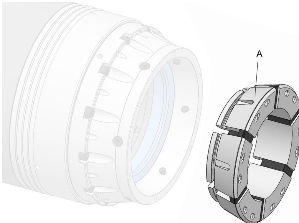
A Spannkopf [Spannelement]
