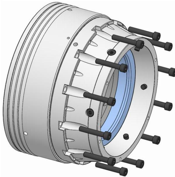
4. Die Befestigungsschrauben Funktionseinheit lösen und entfernen.
