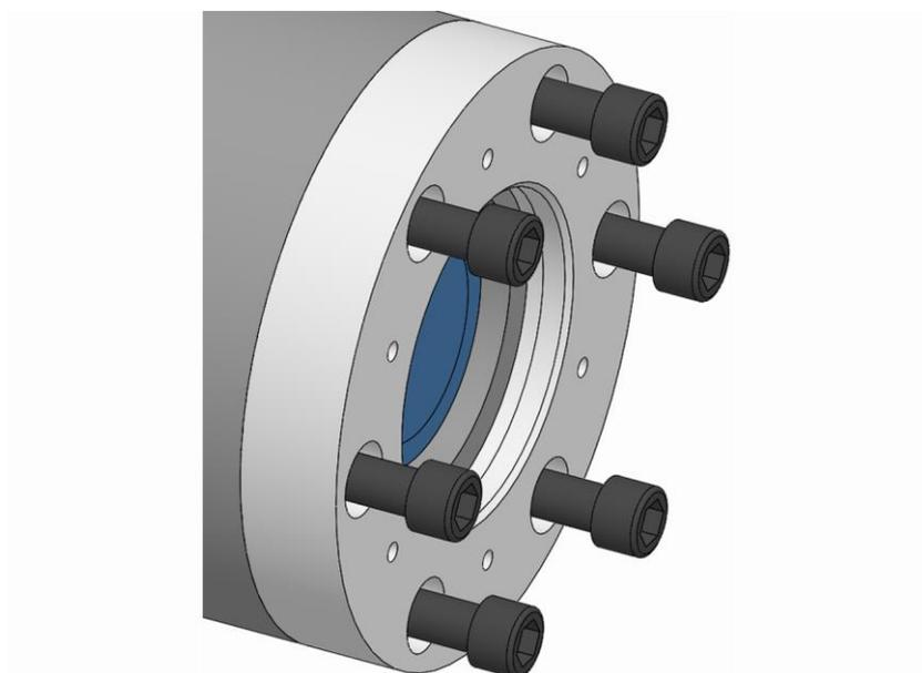
3. Die Befestigungsschrauben Spindelflansch lösen und entfernen.
