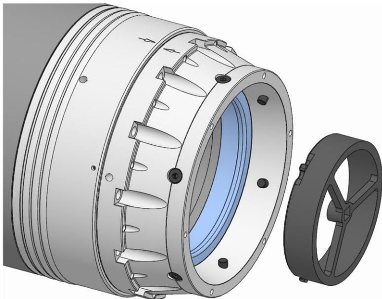
6. Die Montagehilfe in die Funktionseinheit einsetzen, so dass die Montagehilfe in die Nuten des Zugrohradapters der Funktionseinheit eingreift.
