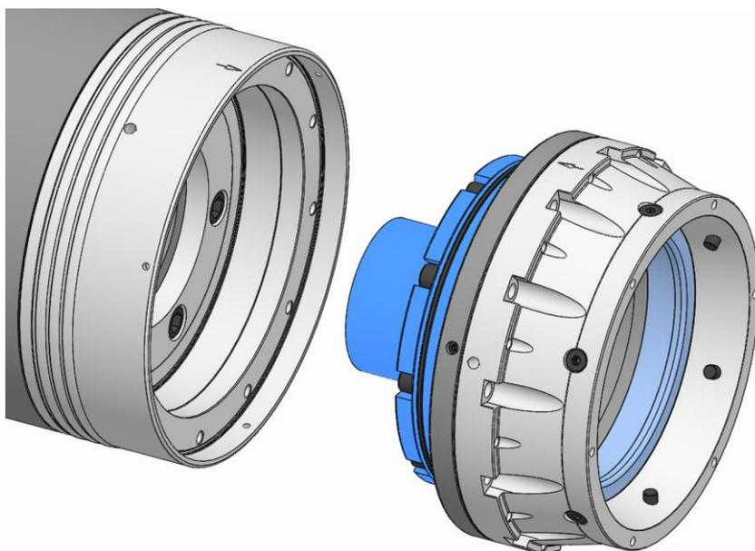
9. Die Funktionseinheit von dem Spindelflansch herunternehmen.
