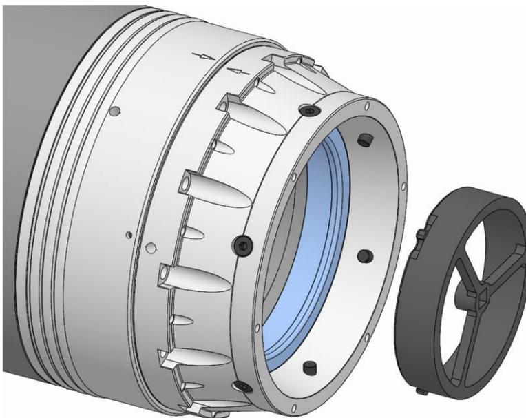
8. Die Montagehilfe aus der Funktionseinheit herausnehmen.
