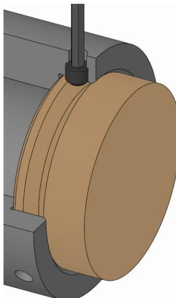
1. Die Klemmschrauben Wechselteil herausdrehen bis sich das Wechselteil herausnehmen lässt.
