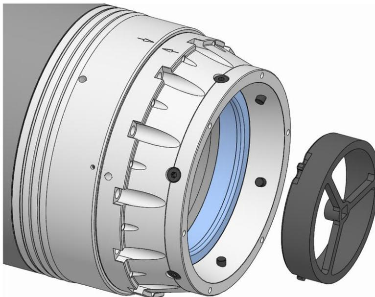
7. Die Montagehilfe aus der Funktionseinheit herausnehmen.
