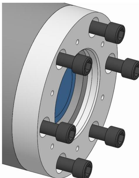
4. Die Befestigungsschrauben Spindelflansch einschrauben und diese mit dem vorgeschriebenen Anzugsdrehmoment festziehen [siehe Kapitel »Schraubenanzugsdrehmomente«].
