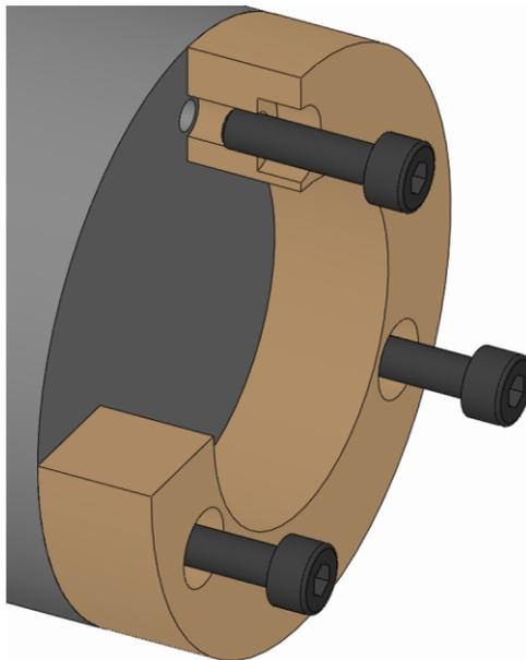
1. Die Befestigungsschrauben Wechselteil lösen und entfernen.
