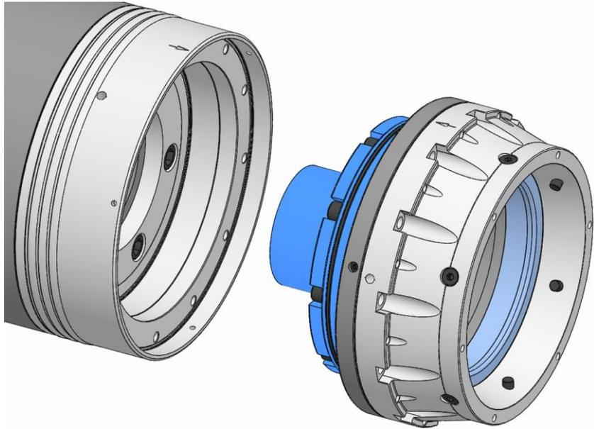
4. Die Funktionseinheit auf den Spindelflansch aufsetzen, sodass die Wuchtmarkierungen am Spindelflansch und der Funktionseinheit übereinstimmen.
