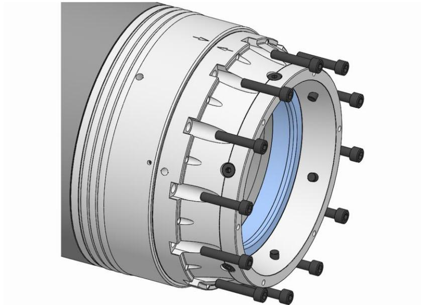
4. Die Befestigungsschrauben Funktionseinheit lösen und entfernen.
