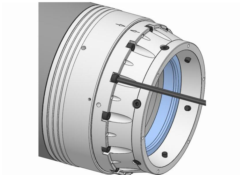
13. Die Befestigungsschrauben Funktionseinheit mit dem vorgeschriebenen Anzugsdrehmoment festziehen [siehe Kapitel »Schraubenanzugsdrehmomente«].
