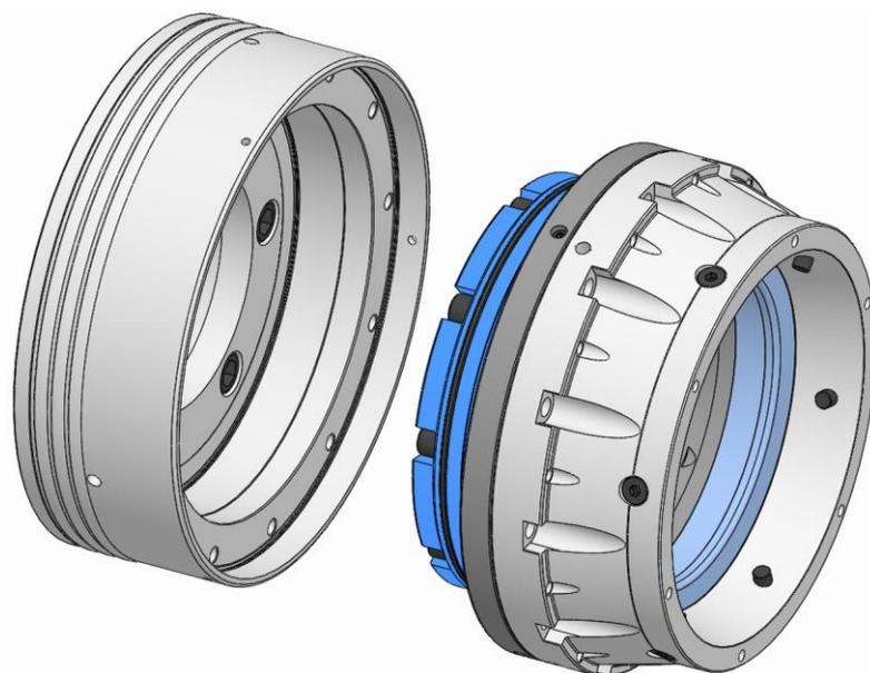
5. Die Funktionseinheit von dem Spindelflansch herunternehmen.
