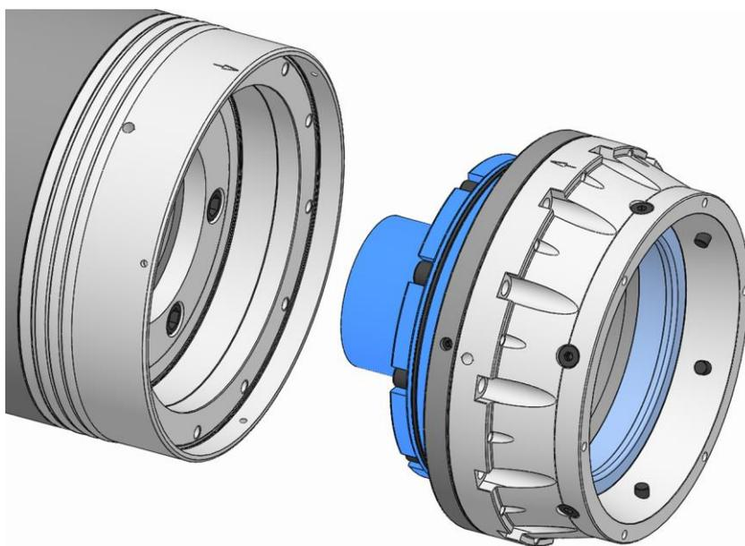
4. Die Funktionseinheit auf den Spindelflansch aufsetzen, sodass die Wuchtmarkierungen am Spindelflansch und der Funktionseinheit übereinstimmen.
